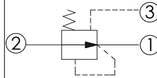
例: 前置型壓力補償比例流量控制迴路
