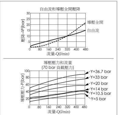
• 提動軸歸位,口①到口②的最大內漏量: Y= 0200, 0330, 0367:在低於開啟壓力:14 bar情况下,內漏量:(0.4 cc/min) 0050, 0105, 0140:在低於開啟壓力:3.5 bar情况下,內漏量:(50 cc/min)
